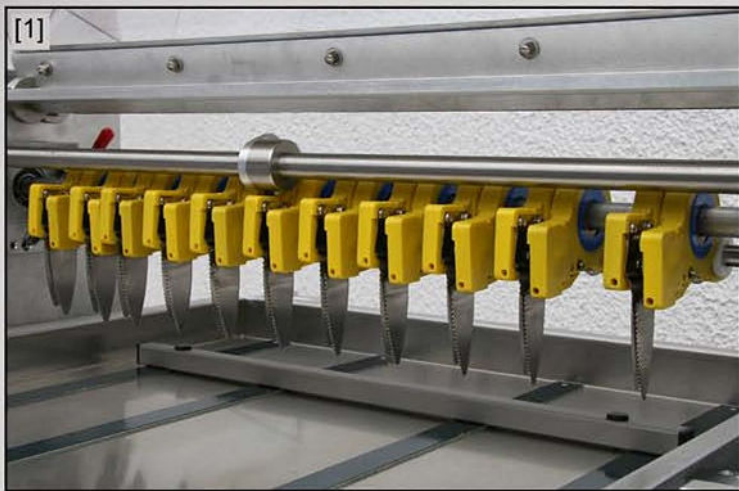
[1] Système de double couteau KR DUO breveté pour la meilleure qualité de coupe.
