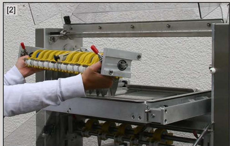
[2] Barres de couteaux amovibles et échangeables
