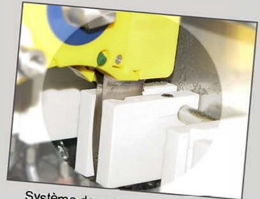
Système de nettoyage à pression avec de l'eau à 70°C.
